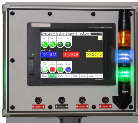
3-stufige automatische Prozessablaufsteuerung und Voreinstellung der Beschichtungs-parameter vom Touchscreen- Bedient-Terminal (DBS XXA-45-Steuerung).
